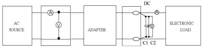
C1: 0.1uF CERAMICS CAPACITOR C2: 10uF 50V ALUMINUM CAPACITOR
